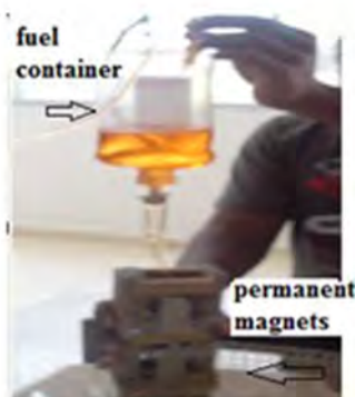
Fig. 9. (a) Dégroupage des molécules d'hydrocarbures, (b) Montage expérimental pour l'analyse de l'effet du champ magnétique sur la viscosité de l'essence [70].
